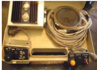
Το Σύστημα Προειδοποίησης Ύψους (Σ.Π.Υ) ελληνικής εμπνεύσεως και κατασκευής με το οποίο εξοπλίσθηκε το MIRAFE F-1CG
